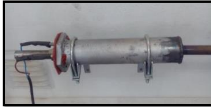
Figura 5.8: Intercambiador de calor
