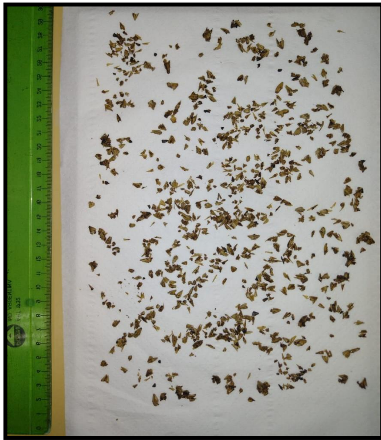
Figura 5.2: Dimensionamiento del tamaño de los granos de bagazo
