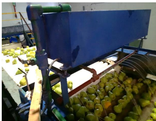
Figura 22. Sistema de aplicación de tubo de PVC perforado.
