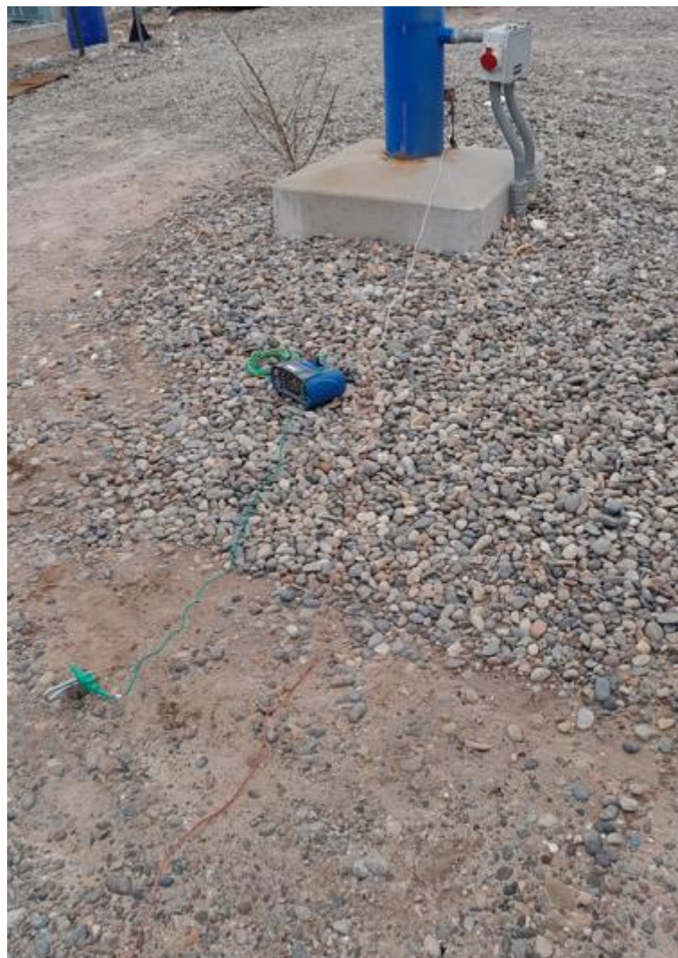
Ilustración 7: Medición de PAT por método caída de potencial con jabalina mas alejada a unos 5mts aproximadamente.
