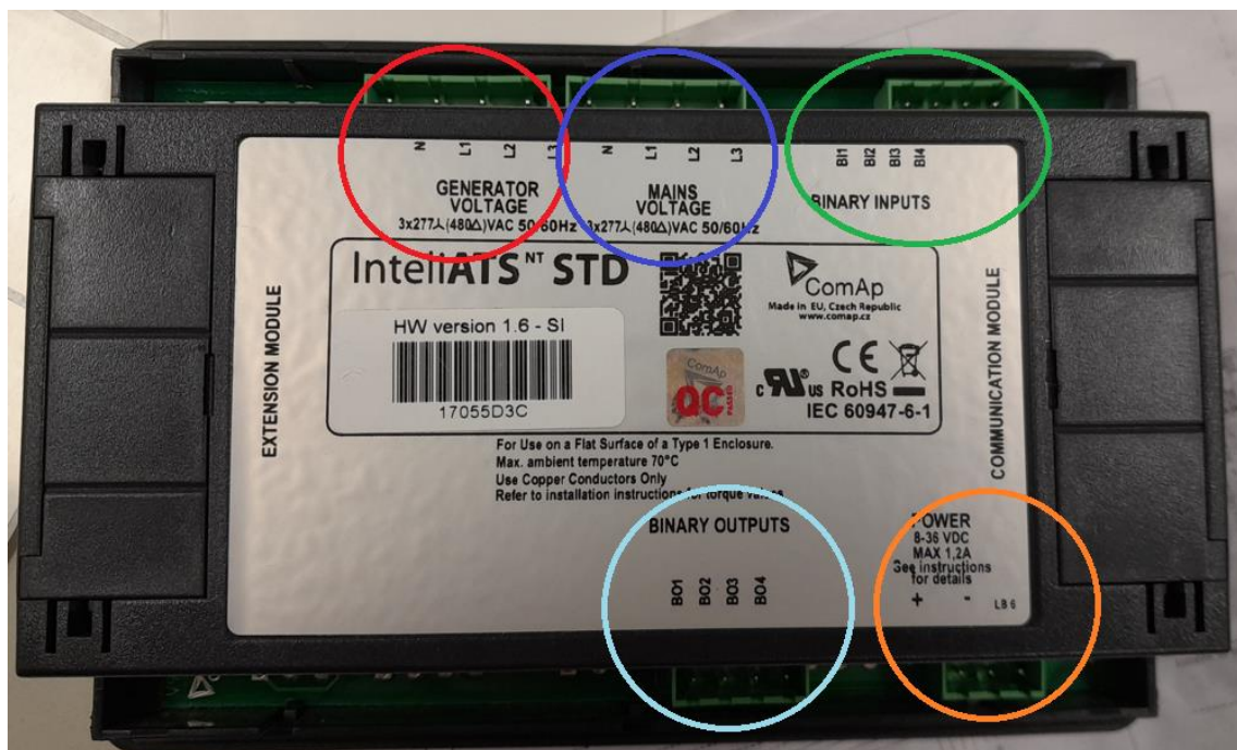
Ilustración 60: nuevo controlador con sus borneras de conexión identificadas
