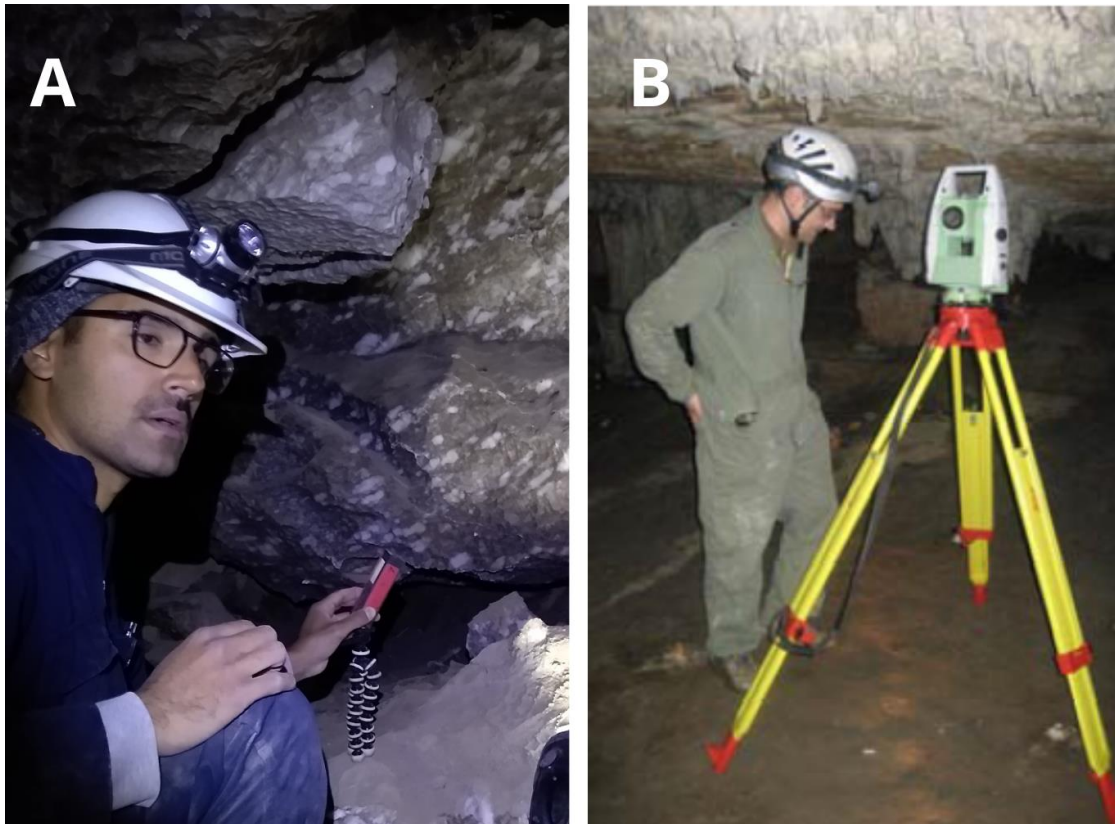
Figura 4-8: A: Leica DISTO™ X310 utilizado en la Cueva del León. B: Estación total en levantamiento topográfico. Tomado de Domínguez-Cuesta et al. (2012).
