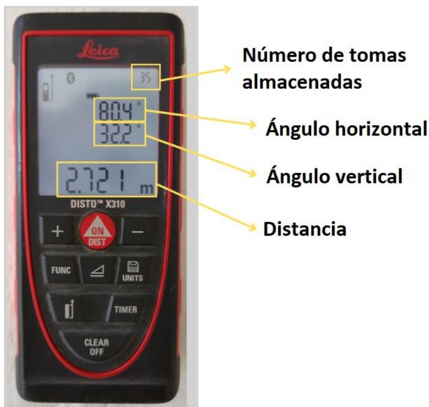
Figura 5-1: Distanciómetro láser Leica DISTO™ X310 utilizado en el mapeo de la Cueva del León.
