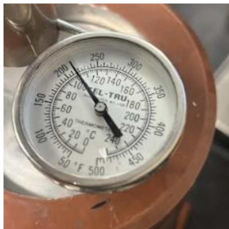
Figura 5.14: Termómetro de la camisa calefactora al orificio del termopar en la parte superior de la celda de prueba.
