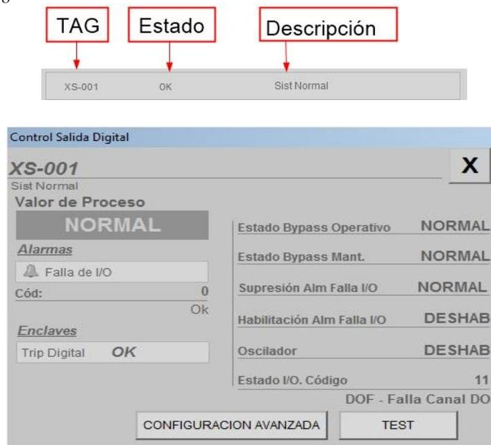
*Nota.* Detalle de Faceplate salida digital con todas sus partes
