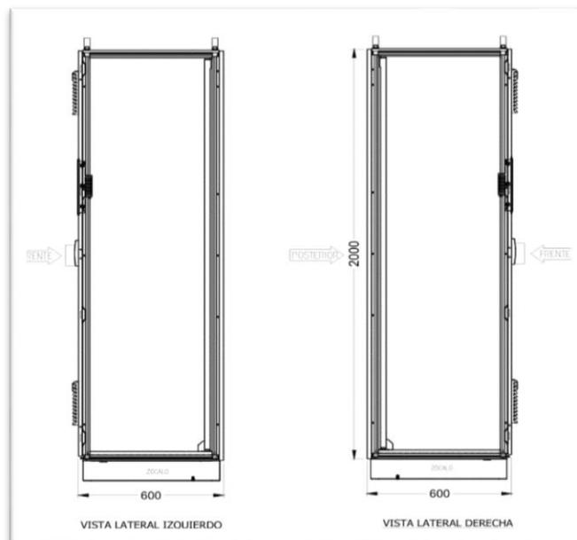
*Nota. Esquema de los laterales del tablero con dimensiones*
