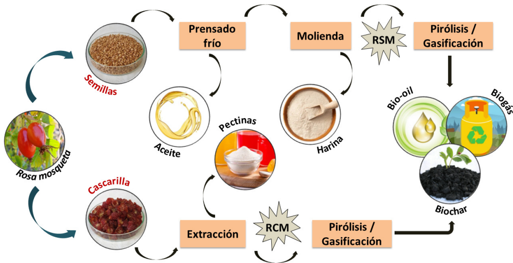
Figura 6.1: Esquema de las etapas de una biorrefinería para el procesamiento del escaramujo (pseudo-fruto) de rosa mosqueta.
