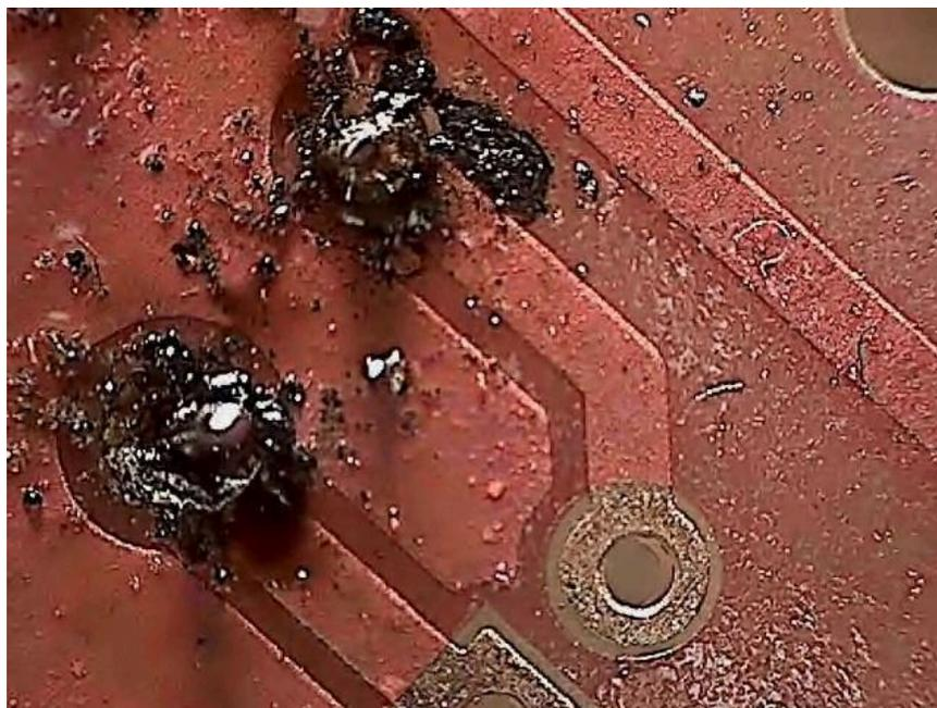
Figura 1: Mala soldadura, con escoria, sin embargo la placa seguía funcionando
