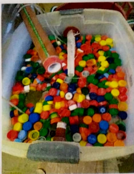
Figura 2. Biofiltro construido en base a la utilización de tapas rosca para gaseosas (datos propios).
