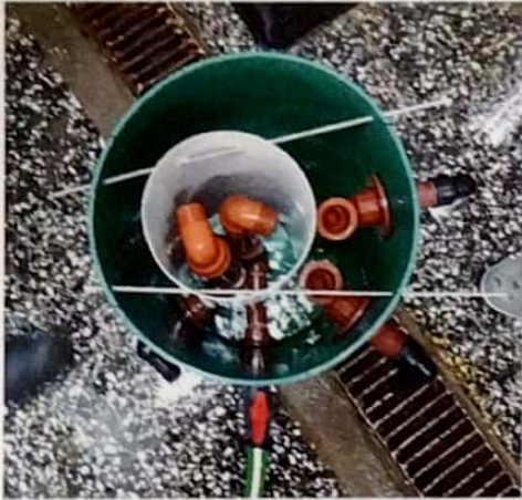
(Figura 4) Tacho de plástico modificado especialmente para la sedimentación de los desechos más grandes del cultivo
