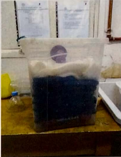
(Figura 6) Primer filtro mecánico y biológico empleado.
