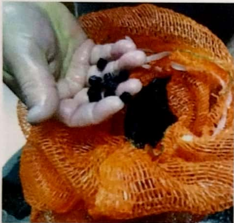
(Figura 8) Pequeñas piezas de PVC Biodiscos contenidas en la bolsa de red del filtro biológico.
