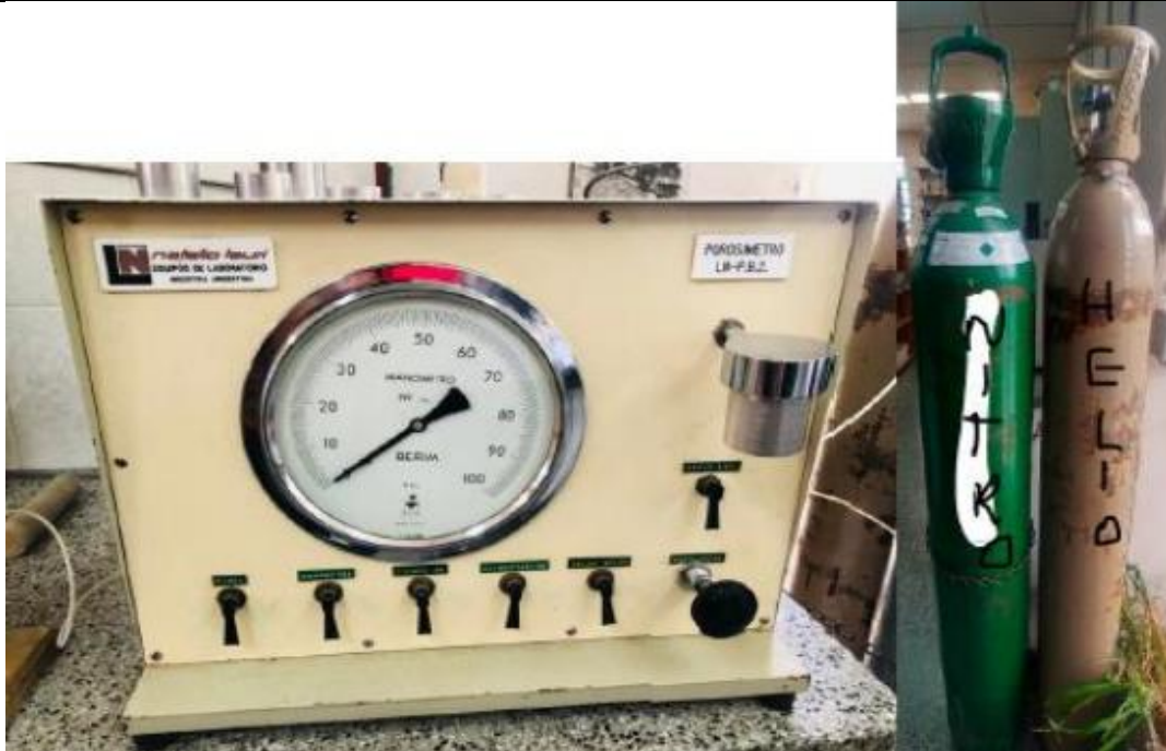
Figura 25. Porosímetro de helio, junto a tubos de nitrógeno y helio.
