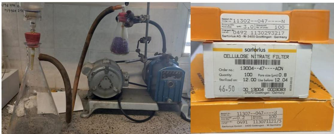
Figura 8: Equipo de filtrado y filtros utilizados
