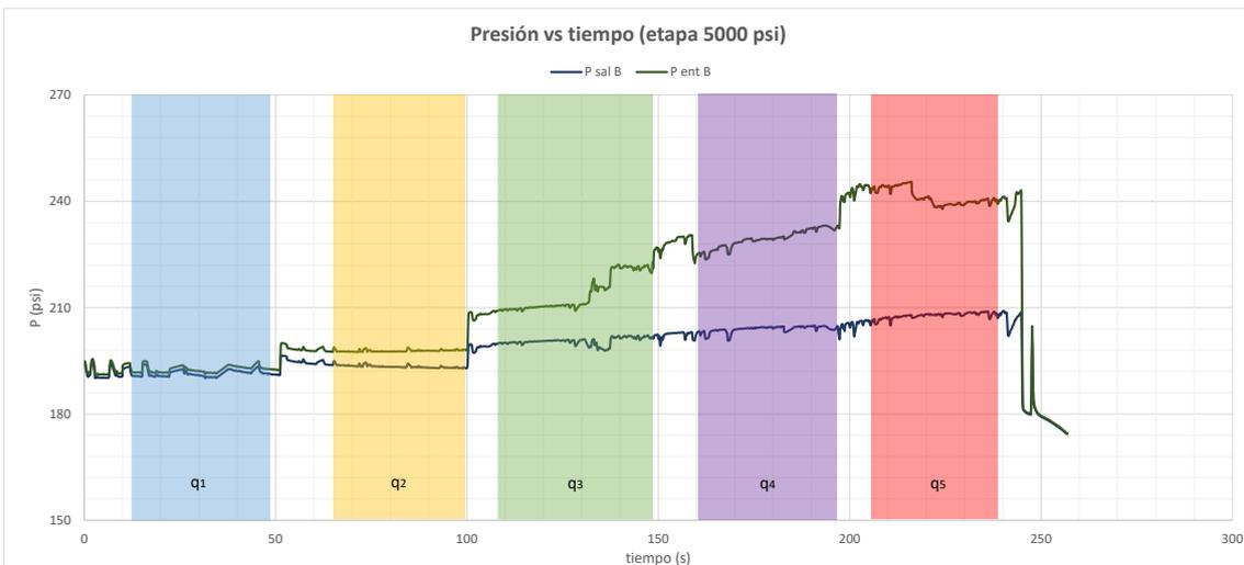
Figura 43: Presión vs tiempo etapa 5 muestra fracturada
