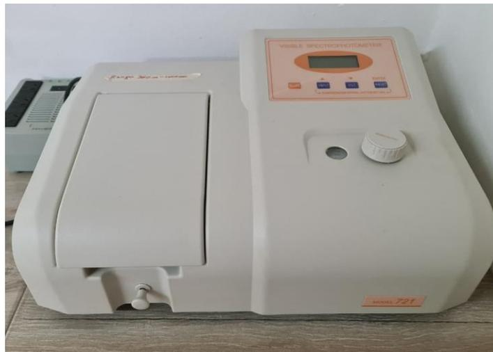
*Figura 22. Espectrofotómetro UV-Vis*
