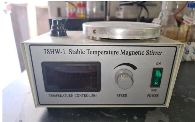
Figura 23. Agitador magnético
