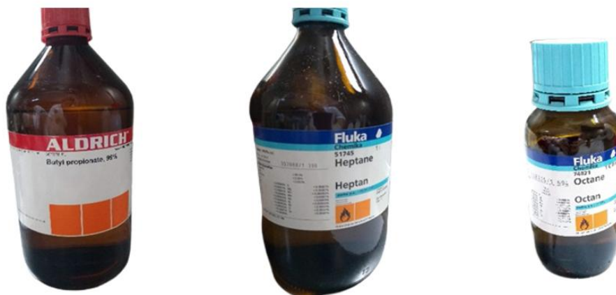
Figura 6. Sustancias puras utilizadas, de izquierda a derecha: Propanoato de Butilo, Heptano y Octano.
