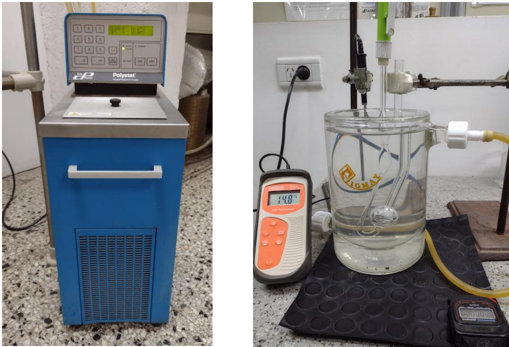
Figura 17. A la izquierda, Termostato Polystat. A la derecha, se puede observar el viscosímetro montado vertical dentro del baño de manera que los aforos queden a la vista, el termómetro digital y el cronómetro.
