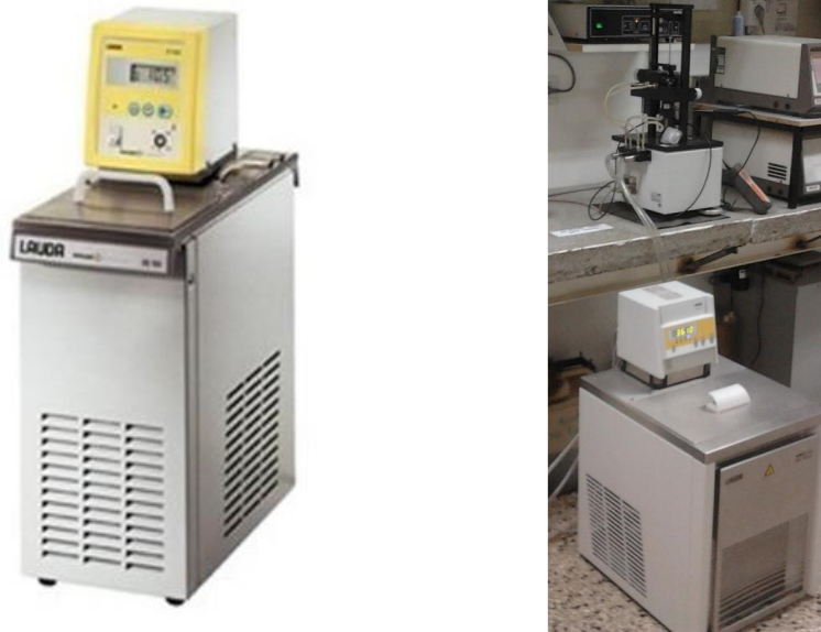
Figura 15. Baño LAUDA RP 1840, que se utilizó para regular la temperatura del fluido refrigerante. A la derecha, se observa el termostato y su conexión con el tensiómetro LAUDA TVT2.
