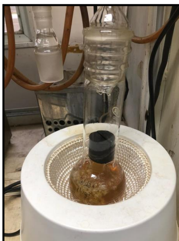
Imagen N° 3: Lavado con Metanol de la muestra “ plug ”.
