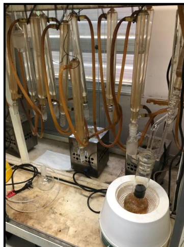
Imagen N° 2: Equipo de lavado con la muestra “ plug ”.
