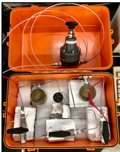
Imagen N° 20: Equipo usado durante las pruebas de fuga.
