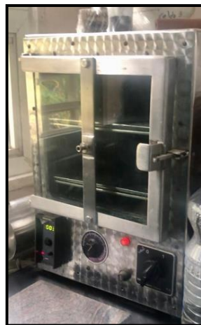
Imagen N° 7: Estufa usada para el secado de muestra “ plug ” y “trozos sueltos”.
