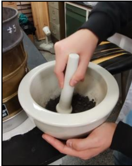
Imagen N° 11: Trituración de muestras en mortero mayor.
