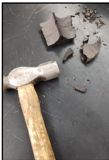
Imagen N°8: Trituración mecánica de las muestras.
