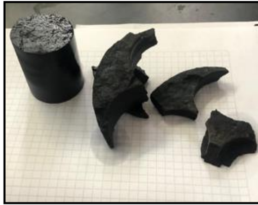
Imagen N° 6: Muestra “ plug ” y “trozos sueltos” luego de ser lavadas con Metanol y Tolueno.
