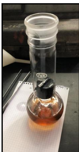
Imagen N° 4: Lavado con Tolueno de la muestra “ plug ”.
