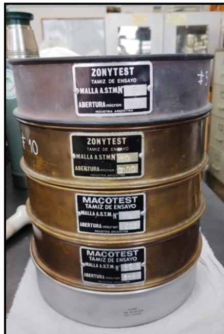
Imagen N° 12: Moldes de tamices ubicados de mayor a menor abertura.
