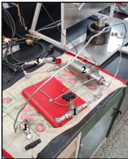
Imagen N° 21: Dispositivos del equipo para el Método del Decaimiento del Pulso de Presión, siendo 1- Válvulas esféricas. 2- Celda aguas arriba y 3- Transductor de presión.
