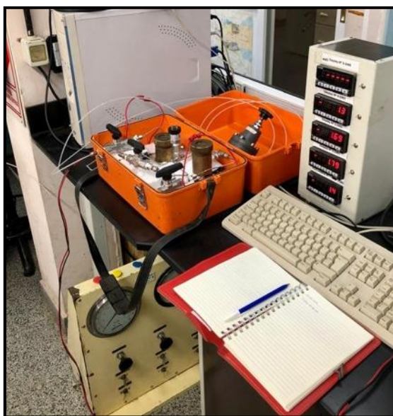
Imagen N° 19: Instalación del equipo para las pruebas de fuga.
