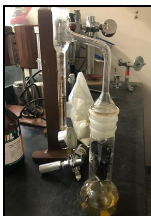
Imagen N° 5: Lavado con Tolueno de la muestra “ trozos sueltos ”.
