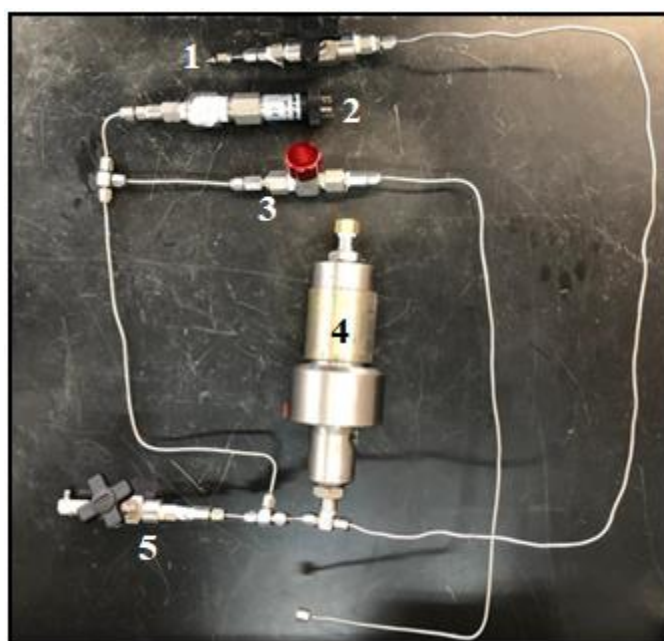
Imagen N° 24: Elementos de la configuración “aguas arriba” conectados, siendo: 1- Válvula esférica, 2-Transductor de presión, 3-Válvula esférica, 4-Celda aguas arriba y 5- Válvula esférica.
