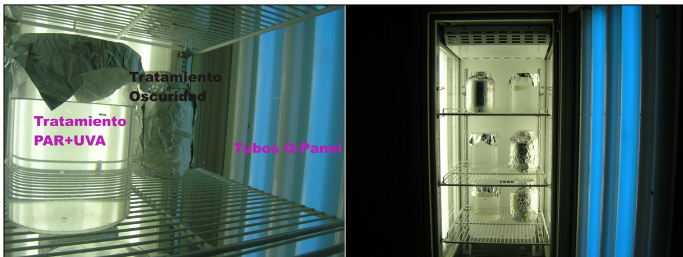
Figura 1.8: Incubaciones experimentales de Boeckella spp: tratamientos de radiación PAR+UVA y oscuridad (panel izquierdo). Arreglo de tubos fluorescentes y Q-panel 340 en el incubador SANYO MLR50 y réplicas pertenecientes a los tratamientos PAR+UVA y oscuridad (panel derecho).
