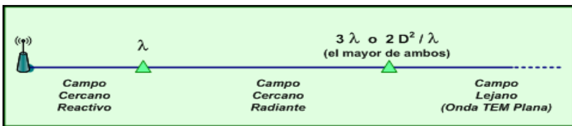
10 Fig. Distribución del campo cercano y campo lejano con respecto a la fuente de emisión (Fuente: Comisión Nacional de Comunicaciones).
