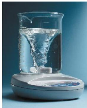
*Figura 17- Representación del vórtice necesario para el agregado de polímero*
