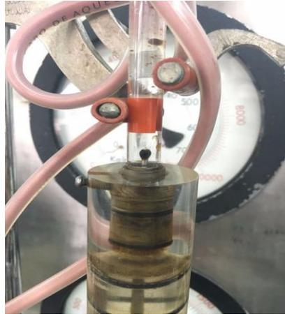
*Figura 35- Separación bifásica del petróleo producido y los fluidos de inyección.*
