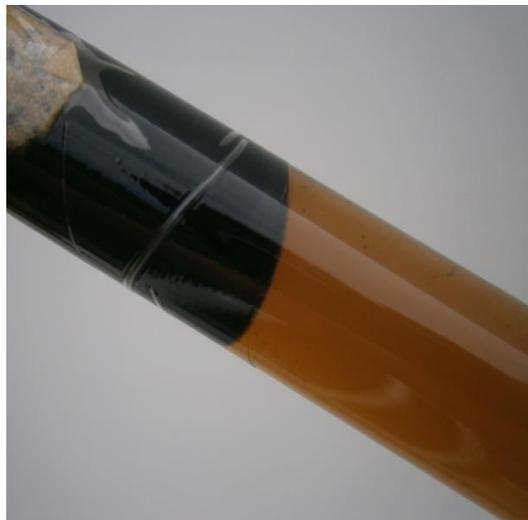
*Figura 32- Muestra del contacto Petróleo-PSA luego de 24 horas a 80°C*
